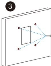
**3** Entfernen Sie die Wandhalterung. Benutzen Sie danach eine Bohrmaschine mit 5mm-Bohrer, um die vier Befestigungslöcher an den vorher markierten Stellen auf der Wand zu bohren.
