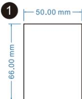
**1** Bohren Sie ein viereckiges Loch in der Wand (Höhe\*Breite\*Tiefe = 66\*50\*50mm) und zwar entsprechend der Position der Kabel in der Wand und das für alle Kabel passend ist.
