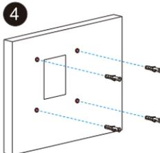
**4** Sobald die Befestigungslöcher gebohrt worden sind, führen Sie die mitgelieferten Schraubendübel ein.
