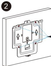
**2** Richten Sie das viereckige Loch mit der Öffnung der Wandhalterung aus und markieren Sie danach durch die Wandhalterung die vier Befestigungslöcher auf der Wand.
