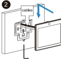
Drücken Sie das Gerät in der Führung der Wandhalterung nach unten, um das Gerät sicher zu befestigen. Benutzen Sie einen Inbusschlüssel, um das Gerät mit einer M3x10,5-Schraube festzuziehen.
