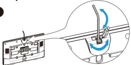
Benutzen Sie einen Inbusschlüssel zur Einstellung des Kamerawinkels, bis Sie den passenden Winkel erreicht haben. Schließen Sie danach den Gummi-Stopfen wieder.
