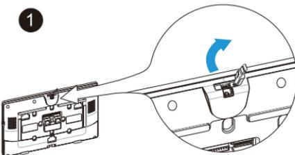
Öffnen Sie den Gummi-Stopfen der Kamera-Einstellungsbohrung.
