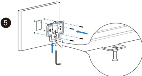
**5** Drehen Sie die M3x10,5-Schraube in das untere Loch der Halterung ein, bis der Kopf mit der Kante ausgerichtet ist. Befestigen Sie danach die Wandhalterung mit vier ST4x20-Schrauben. Falls ein Erdungskabel angeschlossen werden soll, benutzen Sie eine M3x6-Schraube, um es an der Wandhalterung anzuschließen.
